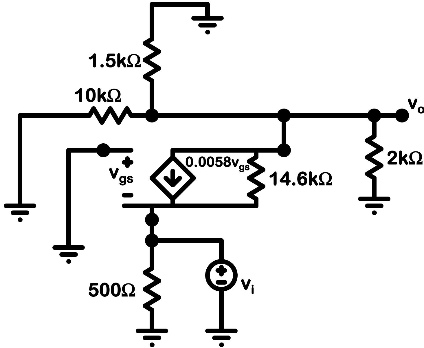
$$V_{gs} = V_g - V_s = -V_i$$
