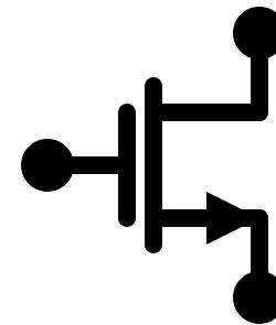
$$i_D(v_{GS}) = 0.5 \cdot k_n \cdot (v_{GS} - V_{tn})^2$$
